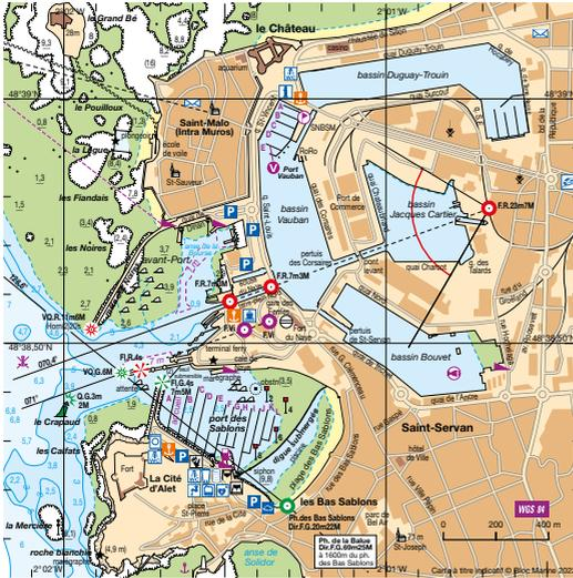
Le port des Sablons est protégé par un môle en enrochements portant un feu à son extrémité. Seuil submersible de retenue d'eau à la côte de 2 m.
